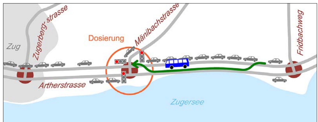
Elektronische Busspur Artherstrasse, Bus überholt auf der Gegenspur.
